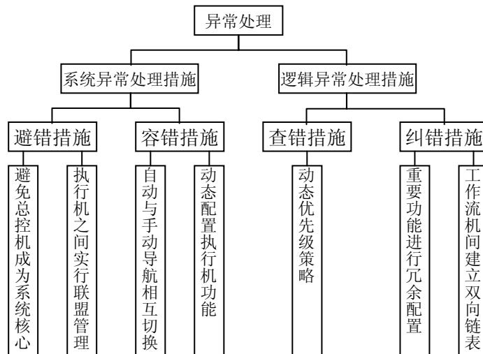
图 3 系统可靠性设计框架
